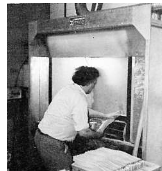
Εικόνα 6. Τοπικά συστήματα απαγωγής σκόνης ξύλου σε διάφορα ξυλουργικά μηχανήματα.
